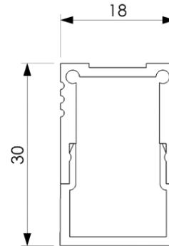
Linearleuchte PICTOR HOCH, farblos eloxiertes Aluminiumprofil, Abdeckung opal hoch clickbar, Montage mit Montageklammer, Konverter extern
