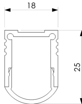
Linearleuchte PICTOR HALBRUND, farblos eloxiertes Aluminiumprofil, Abdeckung opal halbrund klickbar, Montage mit Montageklammer, Konverter extern
