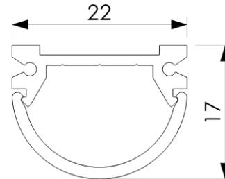
Linearleuchte ARA HALBRUND, farblos eloxiertes Aluminiumprofil, Abdeckung opal halbrund klickbar, Montage mit Magnet oder Klammer, Konverter extern
