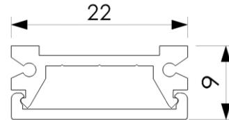
Linearleuchte ARA OPAL, farblos eloxiertes Aluminiumprofil, Abdeckung opal klickbar, Montage mit Magnet oder Klammer, Konverter extern
