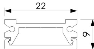
Linearleuchte ARA TRANSPARENT, farblos eloxiertes Aluminiumprofil, Abdeckung transparent flach klickbar, Montage mit Magnet oder Klammer, Konverter extern
