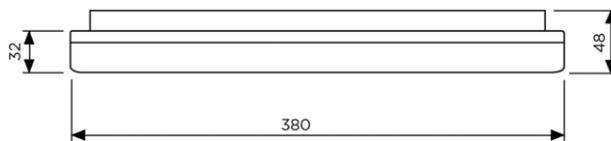
Anbauleuchte ARES 380, weisses Kunststoff-Gehäuse Polycarbonat, Abdeckung opal klickbar, Netzanschlussklemme, Anbau mit Montagebügel und Schrauben (bauseitig), Konverter intern
