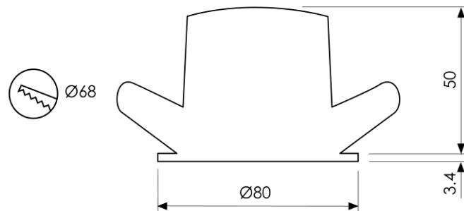
Downlight ARONA DL R80, Aluminiumdruckguss-Gehäuse weiss oder schwarz mit Reflektor silber matt/chrom/schwarz, Einbau mit Clip-Befestigung, LED werkzeuglos tauschbar, Konverter extern (steckbar)
