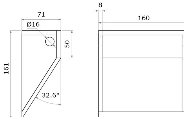
Aussenleuchte CONCRETE WALL, Blende aus farblos eloxiertes Aluminiumprofil, Abdeckung satiniert, Netzanschlussklemme, geeignet für Sichtbeton, Montage mit MDF-Schalungseinlage, Konverter intern
