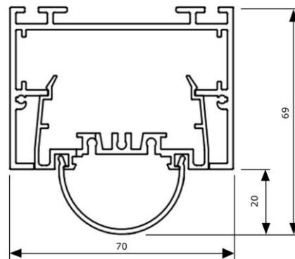
Linearleuchte EM HALBRUND, farblos eloxiertes Aluminiumprofil, Abdeckung opal halbrund klickbar, Durchgangsverdrahtung 5-Pol., Netzanschlussklemme, Montage Pendel mit Drahtseilaufhängung oder Anbau mit Schrauben (bauseitig), Konverter intern
