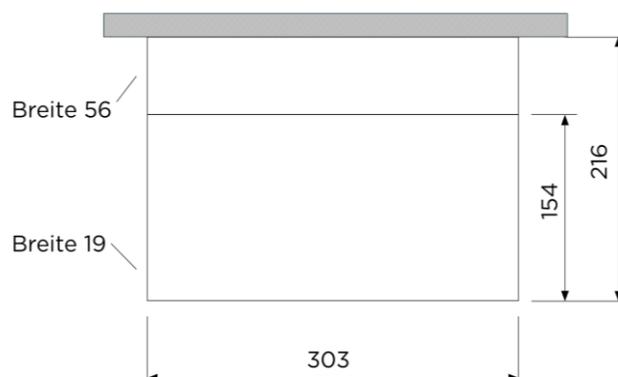
ESCAP-Rettungszeichenleuchte mit 1h Superkondensator-Backup, kompatibel mit Aalto Control (inkl. Lumi Test - Selbstest), Rettungszeichenrahmen aus filigranem Aluminium
