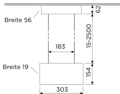
ESCAP-Rettungszeichenleuchte mit 1h Superkondensator-Backup, kompatibel mit Aalto Control (inkl. Lumi Test - Selbsttest), Rettungszeichenrahmen aus filigranem Aluminium mit Seilabhangung
