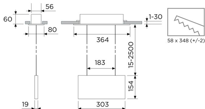
ESCAP-Rettungszeichenleuchte mit 1h Superkondensator-Backup, kompatibel mit Aalto Control (inkl. Lumi Test - Selbstest), Rettungszeichenrahmen aus filigranem Aluminium mit Seilabhangung
