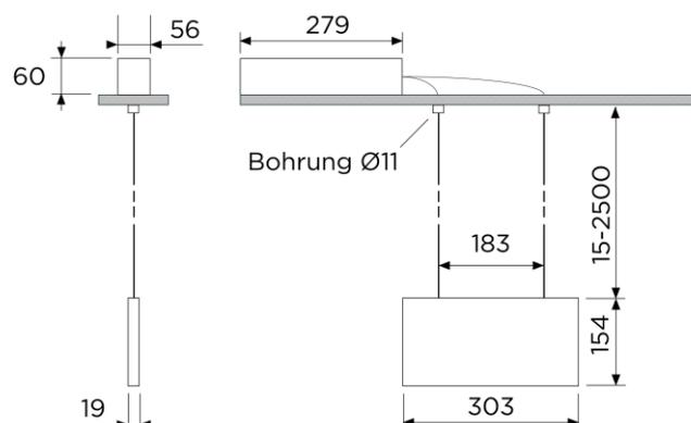
ESCAP-Rettungszeichenleuchte mit 1h Superkondensator-Backup, kompatibel mit Aalto Control (inkl. Lumi Test - Selbstest), Rettungszeichenrahmen aus filigranem Aluminium mit Seilabhangung, Konverter extern (steckbar)
