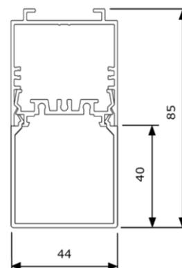
Linearleuchte FILIGRAN HOCH, farblos eloxiertes Aluminiumprofil, Abdeckung opal hoch klickbar, Durchgangsverdrahtung 5-Pol., Netzanschlussklemme, Montage Pendel mit Drahtseilaufhängung oder Anbau mit Schrauben (bauseitig), Konverter intern
