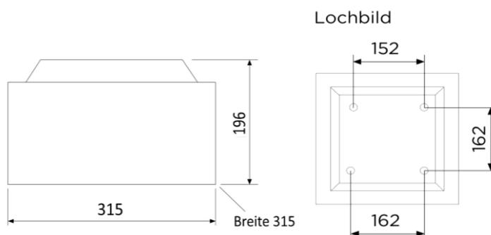
FOUR-SIDED ESCAP-Rettungszeichenleuchte mit 1 h Superkondensator-Backup, kompatibel mit Aalto Control (inkl. Lumi Test -Selbsttest)
