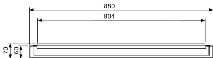
Anbau- und Pendelleuchte LEE SQUARE 33, 4000 oder 3000K, Abdeckung mikroprismatisch unten + seitlich, innenliegende Mikroprismenstruktur und opale Innenhaube, Deckenmontage-Standard/Drahtseilaufhängung mit entsprechendem Zubehör, Konverter intern, erhältlich mit Notlicht
