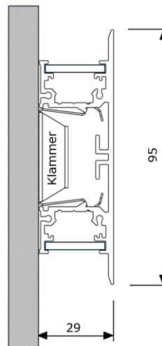
Linearleuchte LIBRA MIKROPRISMA, farblos eloxiertes Aluminiumprofil, Abdeckung mikroprismatisch, Durchgangsverdrahtung 5-Pol., Netzanschlussklemme, Wandmontage Anbau mit Schrauben (bauseitig), Konverter intern
