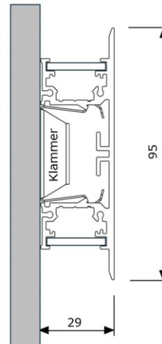
Linearleuchte LIBRA OPAL, farblos eloxiertes Aluminiumprofil, Abdeckung opal, Durchgangsverdrahtung 5-Pol., Netzanschlussklemme, Wandmontage Anbau mit Schrauben (bauseitig), Konverter intern
