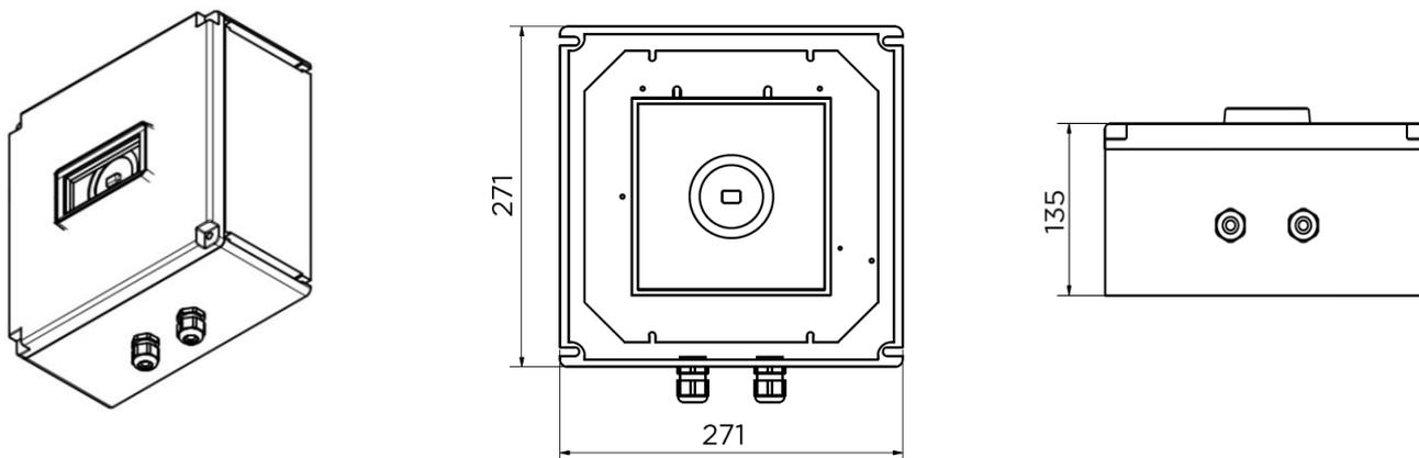
ESCAP-Sicherheitsleuchte LINESPOT II MIDBAY Ex-Zone 2 mit 1 h Superkondensator-Backup, kompatibel mit Aalto Control (inkl. Lumi Test -Selbstest), für Raumhöhen 4-6m
