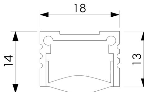
Linearleuchte PICTOR MINI HALBTRANSPARENT 10°, farblos eloxiertes Aluminiumprofil, Abdeckung Linearlinse halbtransparent 10° klickbar, Montage mit Montageklammer, Konverter extern
