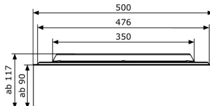
Anbau- und Pendelleuchte RONDO 500 TEXTIL, passives Indirektlicht, Lichtfarbe umstellbar, Abdeckung mikroprismatisch, Stoffschirm seitlich, Deckenmontage-Standard/Pendel/Drahtseilaufhängung mit entsprechendem Zubehör, Konverter intern, erhältlich mit Notlicht und/oder Bewegungs-/Tageslichtsensorik (HF) mit Schwarmfunktion
