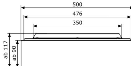
Anbau- und Pendelleuchte RONDO 500 TEXTIL, passives Indirektlicht, Lichtfarbe umstellbar, Abdeckung opal, Stoffschirm seitlich, Deckenmontage-Standard/Pendel/Drahtseilaufhängung mit entsprechendem Zubehör, Konverter intern, erhältlich mit Notlicht und/oder Bewegungs-/Tageslichtsensorik (HF) mit Schwarmfunktion
