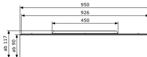
Anbau- und Pendelleuchte RONDO 950 TEXTIL, passives Indirektlicht, Lichtfarbe umstellbar, Abdeckung opal, Stoffschirm seitlich, Deckenmontage-Standard/Pendel/Drahtseilaufhängung mit entsprechendem Zubehör, Konverter intern, erhältlich mit Notlicht und/oder Bewegungs-/Tageslichtsensorik (HF) mit Schwarmfunktion
