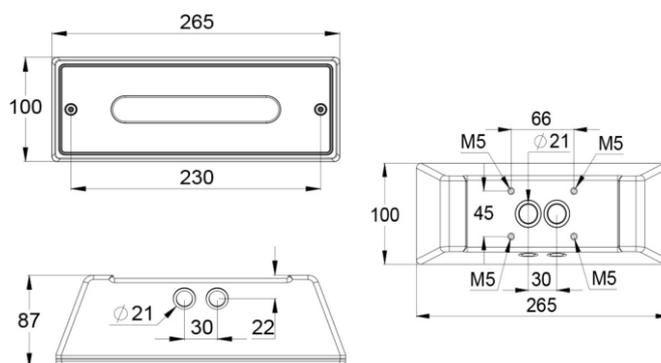
ESCAP-Sicherheitsleuchte mit 1h Superkondensator-Backup, kompatibel mit Aalto Control (inkl. Lumi Test - Selbstest), stoßfestes IK10-Aluminiumgehäuse, für Raumhöhen 4-8m, staub- und wasserdicht, ballwurfsicher
