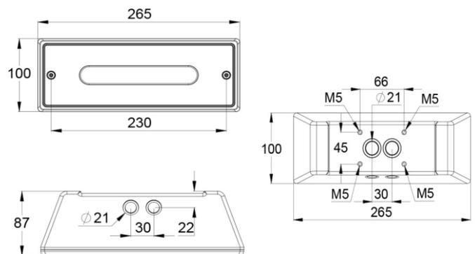
ESCAP-Sicherheitsleuchte mit 1h Superkondensator-Backup, kompatibel mit Aalto Control (inkl. Lumi Test - Selbstest), stoßfestes IK10-Aluminiumgehäuse, für Raumhöhen 4-6m, staub- und wasserdicht, ballwurfsicher
