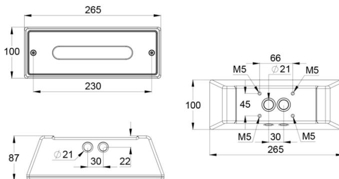
ESCAP-Sicherheitsleuchte mit 1h Superkondensator-Backup, geeignet für Fluchttüren, Tageslichtsensor, kompatibel mit Aalto Control (inkl. Lumi Test -Selbstest), stoßfestes IK10-Aluminiumgehäuse, staub- und wasserdicht, Schalteingang für Bewegungsmelder, ballwurfsicher
