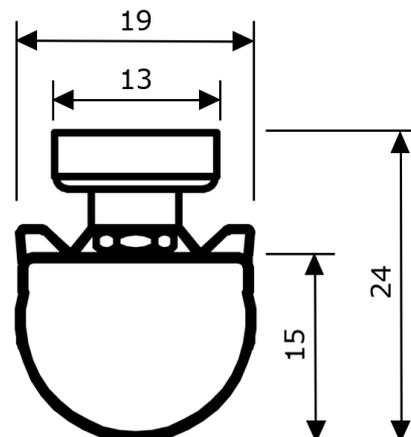
T5/T8 Umrüstsatz 1449mm, flexibel + werkzeuglos positionierbar per Magnet in bestehendem T5/T8-Leuchtgehäuse oder auf sonstigen ferromagnetischen Oberflächen, zusätzliche Lösung falls nicht-magnetisches Leuchtgehäuse, Abdeckung opal halbrund, Lichtfarbe 3000K oder 4000K (Switch), Tridonic Konverter extern inklusive
