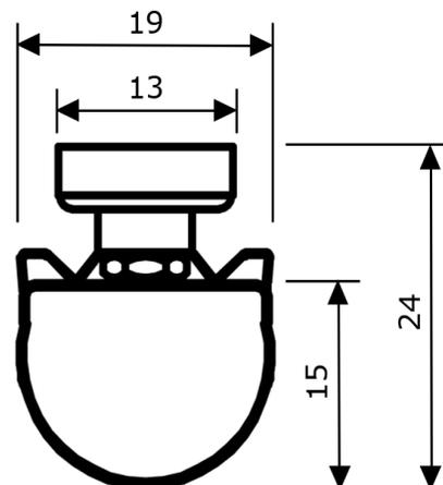
Zweiflammiger T5/T8\* Umrüstsatz 549mm, flexibel + werkzeuglos positionierbar per Magnet in bestehendem T5/T8-Leuchtengehäuse oder auf sonstigen ferromagnetischen Oberflächen, zusätzliche Lösung falls nicht-magnetisches Leuchtengehäuse, Abdeckung opal halbrund, Lichtfarbe einstellbar 3000K oder 4000K (Switch), inkl. 1-kanaliger Konverter extern
