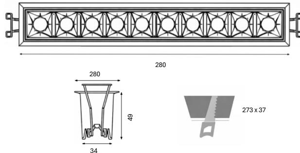
Rechteckige Einbauleuchte QUADRO, Aluminiumdruckguss-Gehäuse grau mit Reflektor schwarz für eine optimale Entblendung, Einbau mit Haltefeder, Konverter extern (steckbar)
