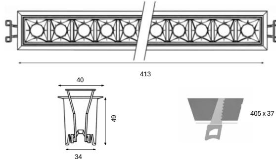
Rechteckige Einbauleuchte QUADRO, Aluminiumdruckguss-Gehäuse grau mit Reflektor schwarz für eine optimale Entblendung, Einbau mit Haltefeder, Konverter extern (steckbar)
