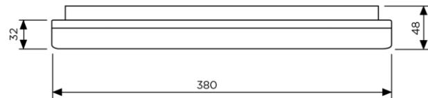
Anbauleuchte ARES 380, weisses Kunststoff-Gehäuse Polycarbonat, Abdeckung opal klickbar, Netzanschlussklemme, Anbau mit Montagebügel und Schrauben (bauseitig), Konverter intern, erhältlich mit Notlicht und/oder Bewegungssensorik (HF)
