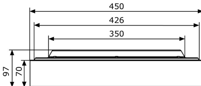
Anbau- und Pendelleuchte RONDO 450 OPAL, 360° Licht, aktives Indirektlicht deaktivierbar, Lichtfarbe umstellbar, weisses PMMA-Gehäuse, Abdeckung opal unten + seitlich, Deckenmontage-Standard/Pendel/Drahtseilaufhängung mit entsprechendem Zubehör, Konverter intern, erhältlich mit Notlicht oder Bewegungs-/Tageslichtsensorik (HF) mit Schwarmfunktion
