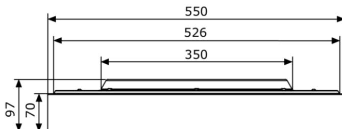
Anbau- und Pendelleuchte RONDO 550 OPAL, 360° Licht, aktives Indirektlicht deaktivierbar, Lichtfarbe umstellbar, weisses PMMA-Gehäuse, Abdeckung opal unten + seitlich, Deckenmontage-Standard/Pendel/Drahtseilaufhängung mit entsprechendem Zubehör, Konverter intern, erhältlich mit Notlicht oder Bewegungs-/Tageslichtsensorik (HF) mit Schwarmfunktion
