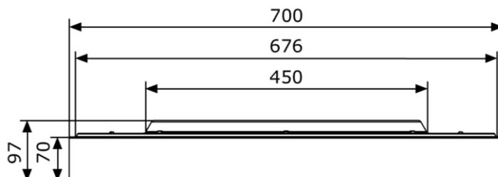
Anbau- und Pendelleuchte RONDO 700 MIKROPRISMA, 360° Licht, aktives Indirektlicht deaktivierbar, Lichtfarbe umstellbar, weisses PMMA-Gehäuse, Abdeckung mikrop Prismatisch unten + opal seitlich, Deckenmontage-Standard/ Pendel/Drahtseilaufhängung mit entsprechendem Zubehör, Konverter intern, erhältlich mit Notlicht und/oder Bewegungs-/Tageslichtsensorik (HF) mit Schwarmfunktion
