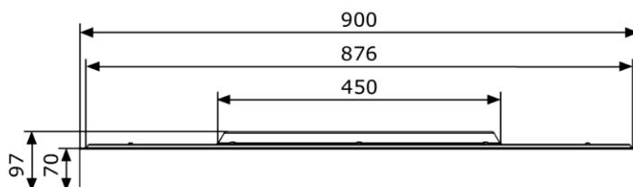
Anbau- und Pendelleuchte RONDO 900 MIKROPRISMA, 360° Licht, aktives Indirektlicht deaktivierbar, Lichtfarbe umstellbar, weisses PMMA-Gehäuse, Abdeckung mikrop Prismatisch unten + opal seitlich, Deckenmontage-Standard/ Pendel/Drahtseilaufhängung mit entsprechendem Zubehör, Konverter intern, erhältlich mit Notlicht und/oder Bewegungs-/Tageslichtsensorik (HF) mit Schwarmfunktion
